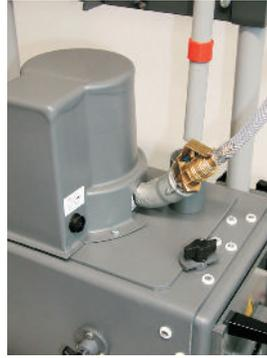
2.) **Steuerleitung** der Nachfülllanze zusammenstecken, an Buchse (Steuerleitung) anschließen und arretieren.
